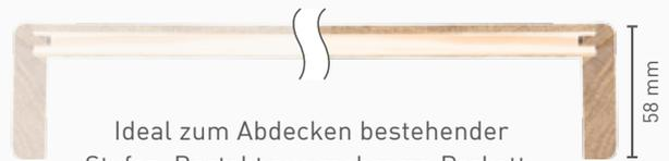
Ideal zum Abdecken bestehender Stufen, Besteht aus mehreren Parkett-Stäben\* und schließt an den Längsseiten jeweils mit einer Multileiste ab. Pro Großformatplatte können **zwei Trittstufen** gefertigt werden.
